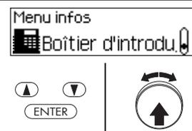
Les paramètres suivants du boîtier d'introduction peuvent maintenant être lus en utilisant les touches flèches ou en tournant le bouton rotatif.
